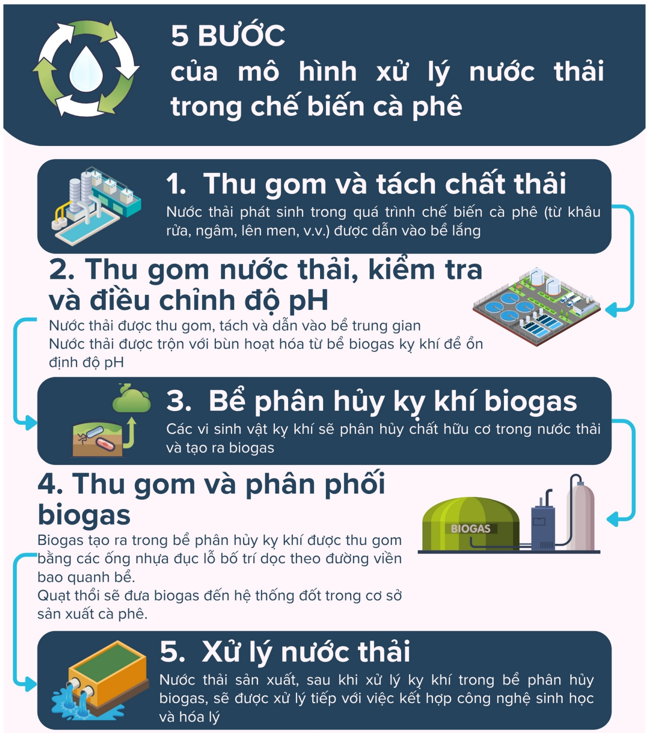
Hình 9. 5 bước xử lý nước thải trong chế biến cà phê
