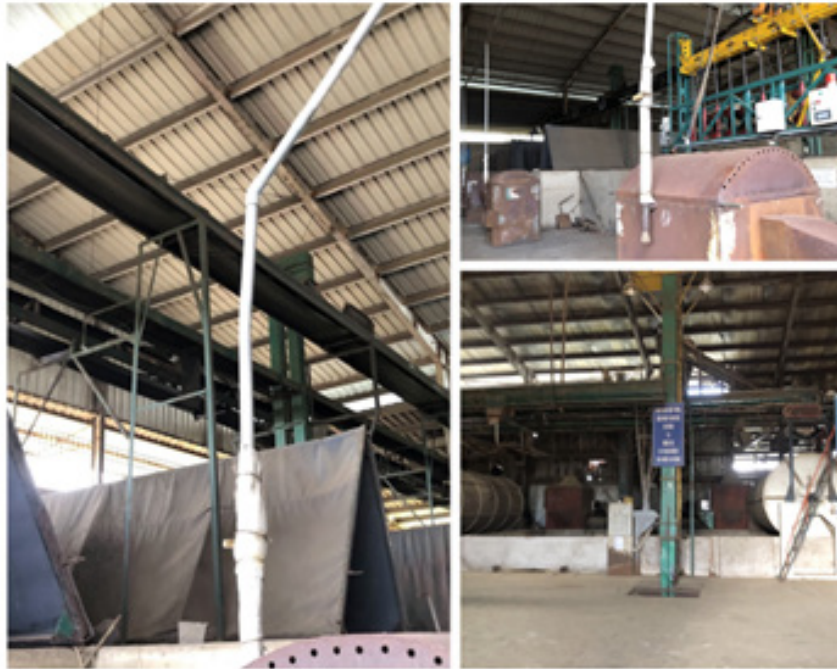
Ảnh 14. Dùng biogas tạo ra từ quá trình xử lý nước thải để sấy cà phê
