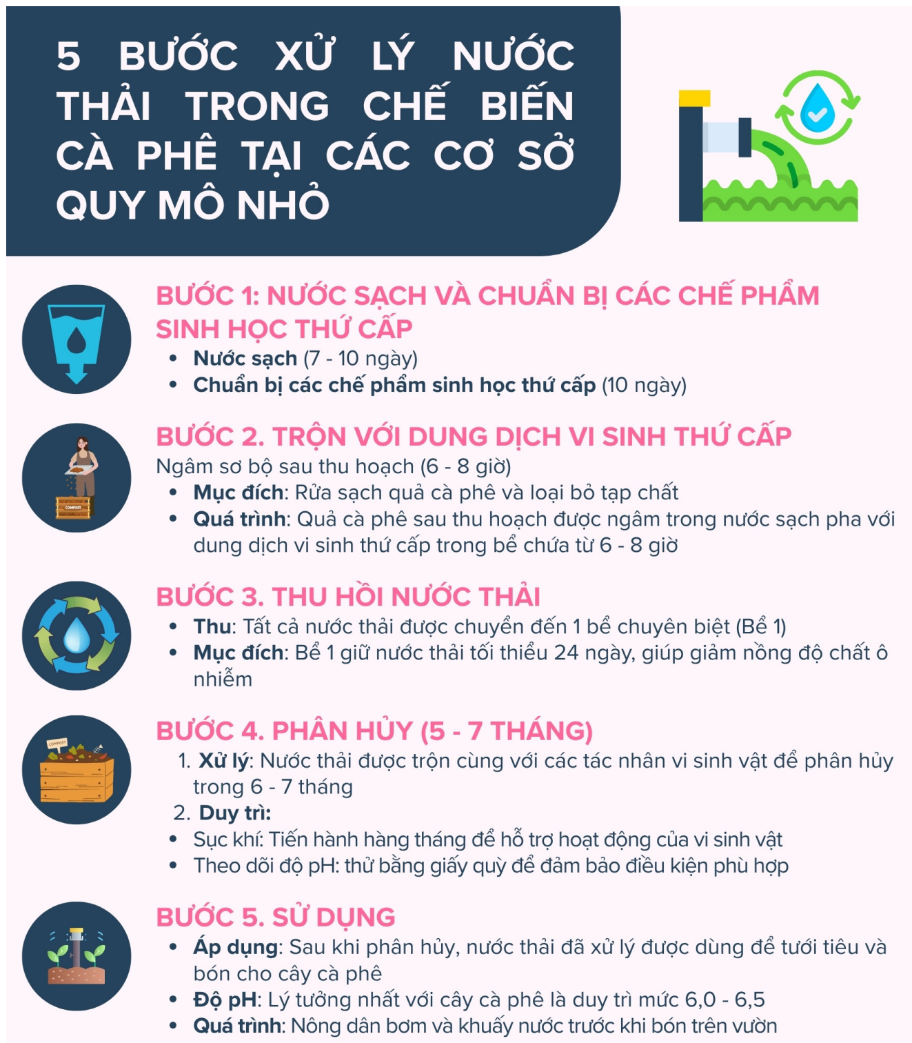
Hình 7. 5 bước xử lý nước thải trong chế biến cà phê tại các cơ sở quy mô nhỏ
